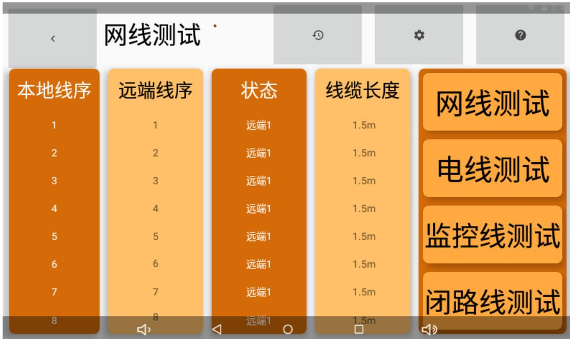
从上图可以发现，本地线序指接在主机上的待测线缆，远端线序指接在副板（远端）的待测线缆，状态指另一端是连接在哪个位置（远端，开路，短路等），线缆长度指此条网线的长度，长度测试范围 2 米~400 米，此界面会一直循环测试，若想要获取每根线芯的结果，则点击右侧的网线测试，电线测试，监控线测试，闭路线测试，出现如下图所示界面。
