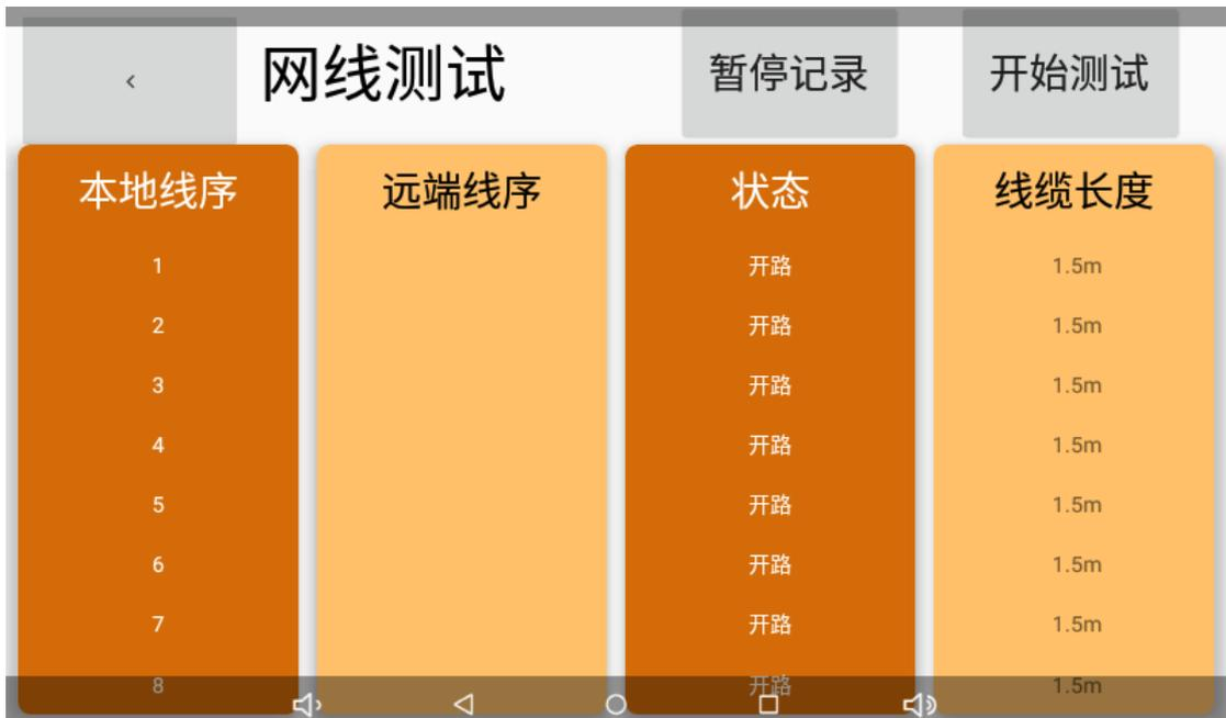
上图所示界面会显示每根线芯的长度，单次测试线缆长度，能够分辨出短路，开路，断路等连接现象。
