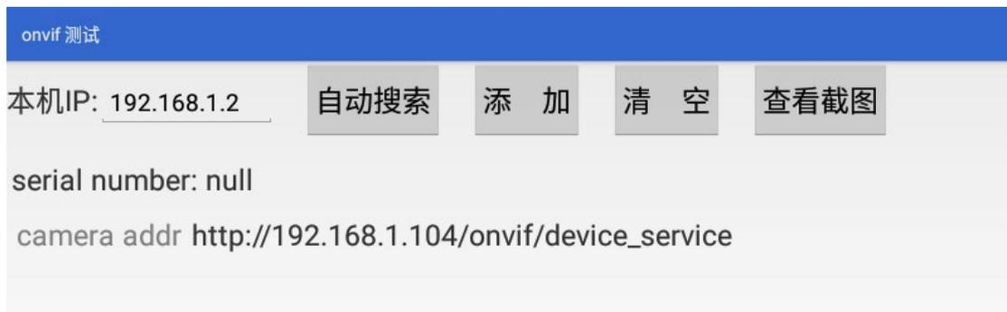
**⚠注意：**如网络摄像头搜索后不显示，建议先拔掉在本仪器“网口”的网线，然后重新插入，待右上方显示连接图标后，再重新搜索。
