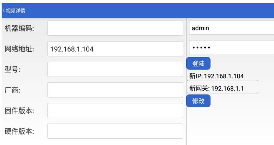
**登陆：**正确输入该网络摄像头的用户名和密码，单击 **登陆** 按钮，若用户名和密码输入正确会提示“登陆成功”，显示屏左侧的“机器编码”、“型号”等属性会自动载入，并且“登陆”按钮会自动变成“播放”按钮，如下图所示。
