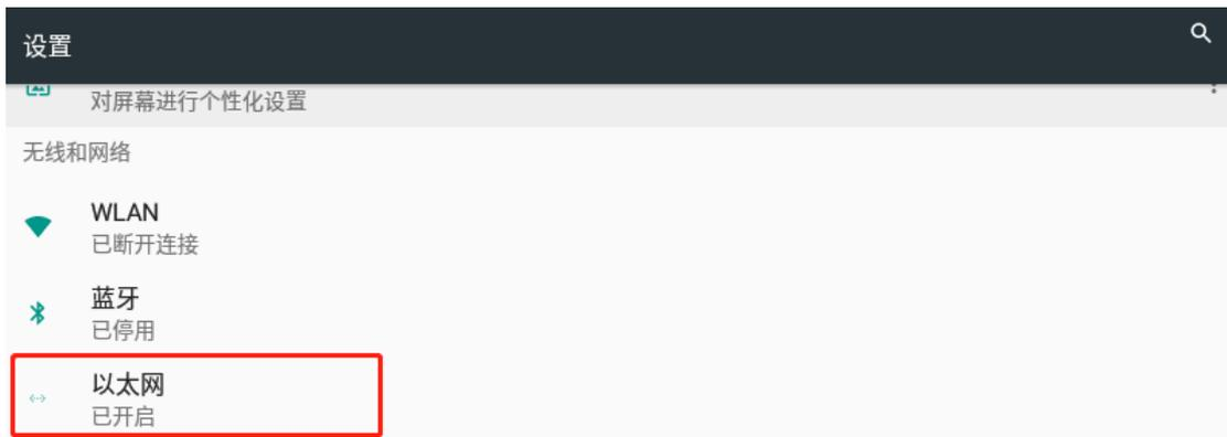
单击“以太网”选项，选择“配置以太网”，在此界面可修改本机的 IP 地址、子网掩码、默认网关和 DNS 服务器等内容。“自动获取 IP”勾选后，将不能修改 IP 地址，用在能分配 IP 地址的交换机或路由器中。如下图所示：
